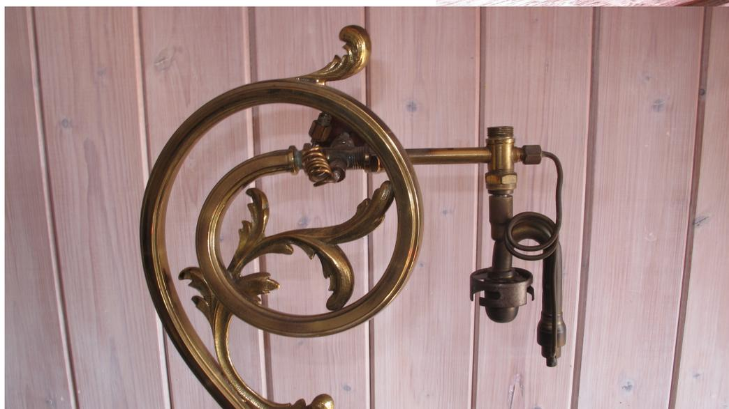
Il se préchauffe par en dessous avec une "taupette" sorte de fourchette en amiante trempée dans l'alcool,
