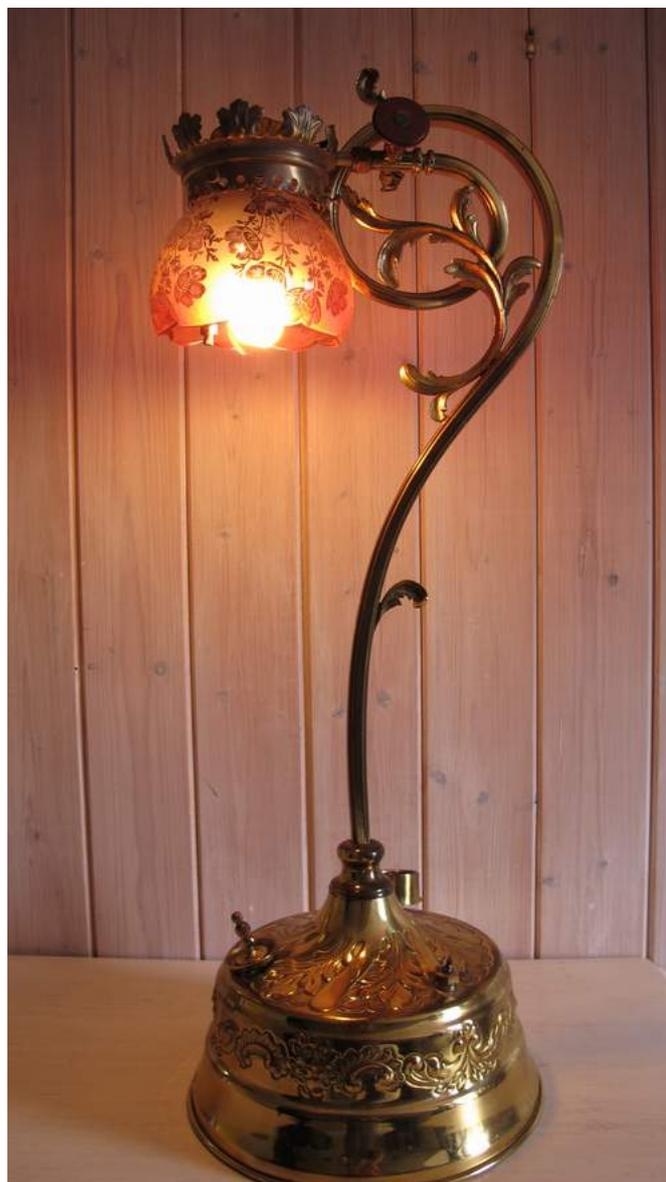
Construite toute en laiton et très ouvragée, il se compose d'un réservoir avec un manomètre de pression et d'une valve de bicyclette pour la pressurisation par l'intermédiaire d'une pompe à vélo. Un robinet à pointeau ferme l'arrivée du carburant à l'entrée du brûleur.
