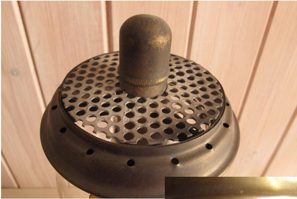
Les écrans à insectes (bug screens) consistent en une tôle ajourée fixée à demeure sur le dessus du brûleur et un système à ressort qui se clipse sur le générateur, sous le verre.
