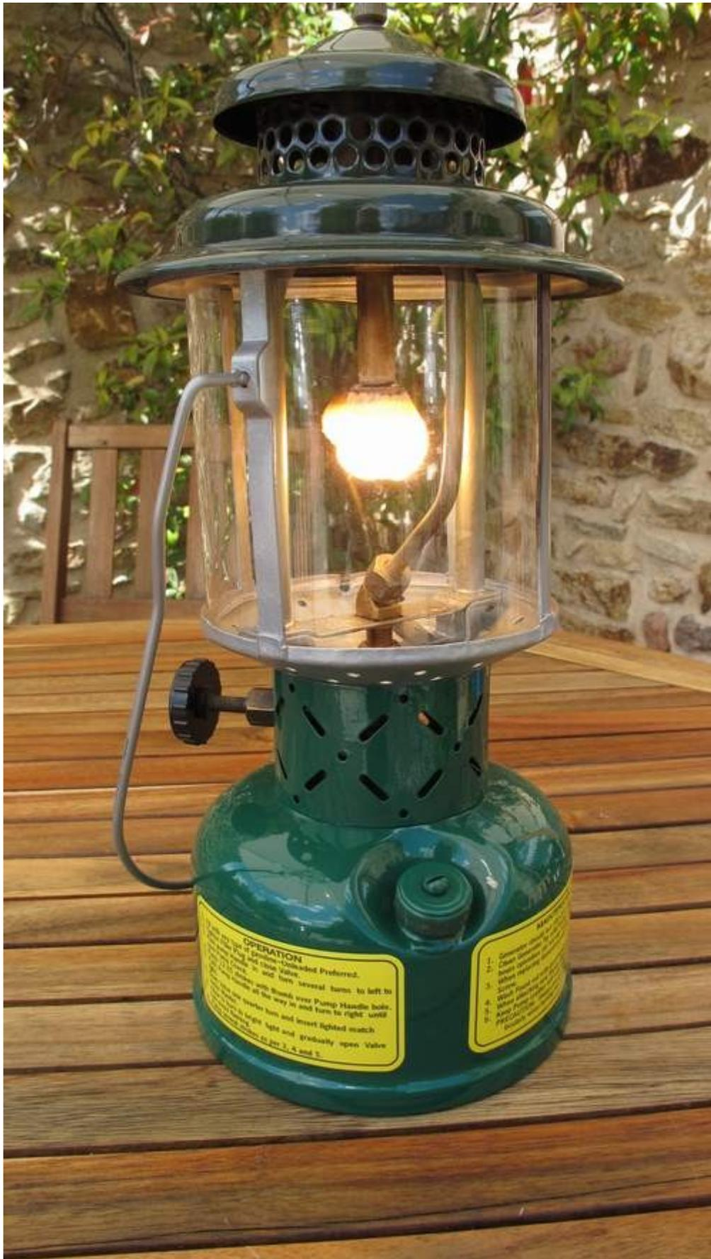
Il faut rappeler que ces lampes ont un réservoir en acier. Il faudra être attentif à ne pas laisser de carburant en cas d'inutilisation de la lampe au risque de voir le générateur bouché par des particules de rouille. Ce type de générateur est très bruyant et pas vraiment performant, l'Armée Américaine ne se souciait pas vraiment du confort de ses GI's ;-), mais c'est adapté aux besoins militaires.
