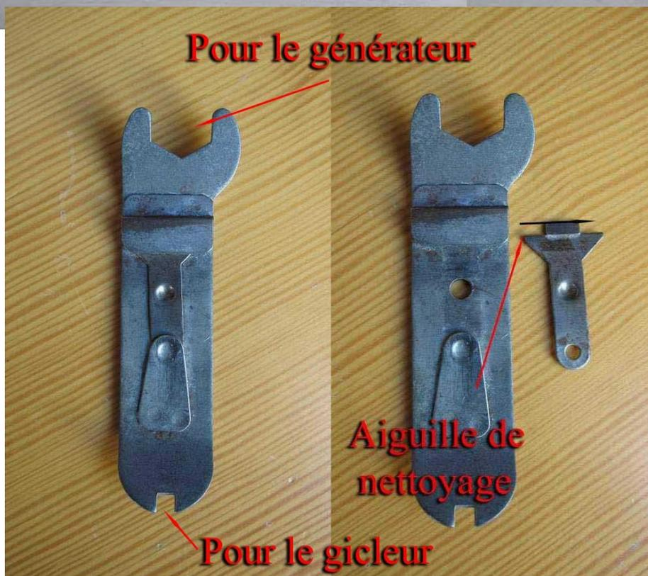
Coleman fournit même l'outillage qui sera coincé sous le support du générateur. Cela suffit à entretenir la lampe et changer le générateur.
