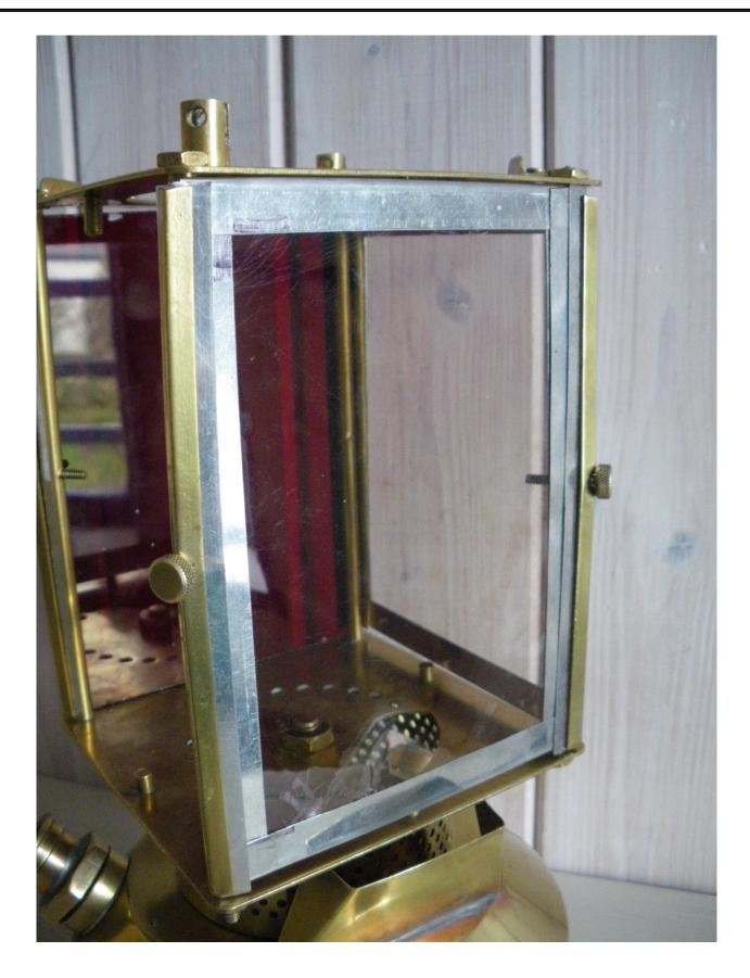
Les panneaux sont reconstitués avec des lattes de fer blanc, pliées et pincées sur les feuilles de mica découpées à la bonne taille. Il n'est pas vraiment besoin de rivet pour tenir le tout en place. Les panneaux sont retenus sur la cage par des mini cornières en laiton et une vis .
