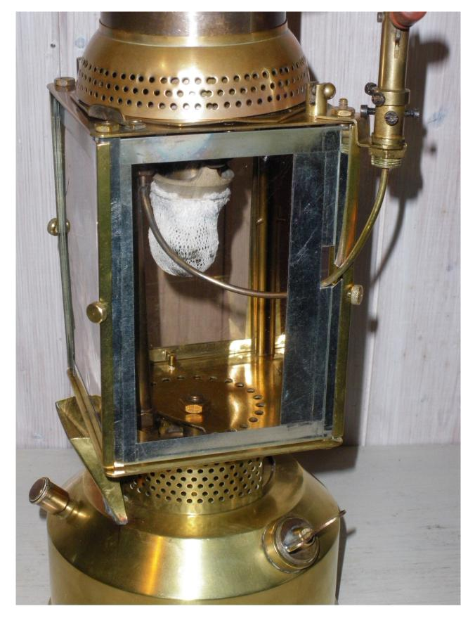
Il est nécessaire de tailler un passage dans le panneau de mica pour laisser passer le tube porte-aiguille qui est vissé sous le gicleur à l'extrémité du générateur.
