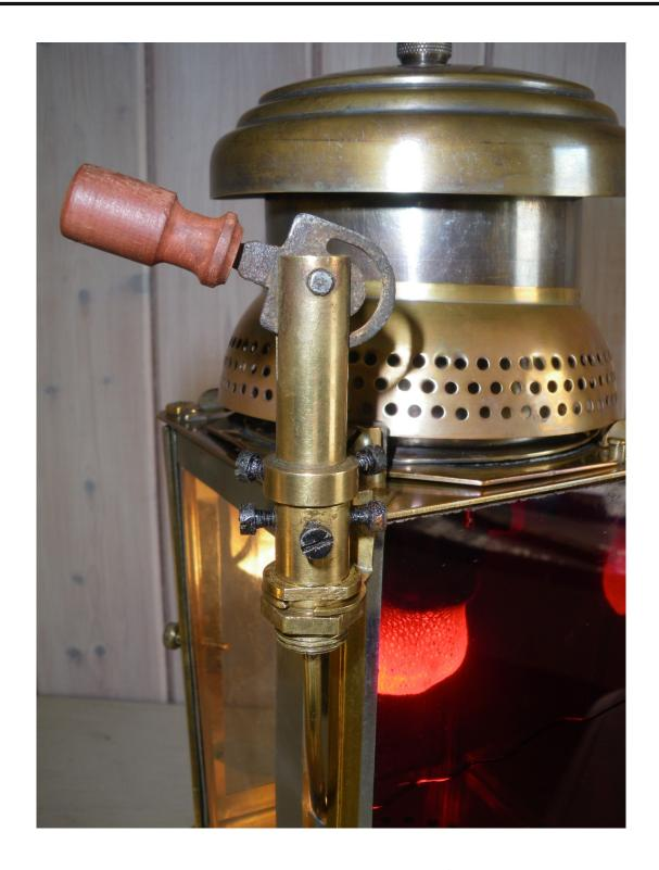
Comme toujours sur ces Guenet, c'est le système de nettoyage par aiguille qui attire l'attention. Il a été breveté en 1922. C'est un système assez sophistiqué qui peut paraître fragile avec cette manette à bascule et ce long tube qui conduit une corde à piano jusqu'au gicleur afin de le nettoyer. Au bout de la corde à piano se trouve l'aiguille de nettoyage. Mais il n'en est rien, ce système est très fiable et très efficace malgré les nombreuses pièces qui le composent.
