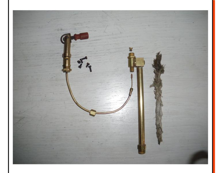
Voici le système de nettoyage en entier. On y voit le générateur droit avec son gicleur ainsi que la bourre d'amiante montée sur un fil de fer torsadé. Cette bourre est enfoncée dans le générateur. Elle sert de filtre et ralenti le flux de l'essence afin de mieux la vaporiser.
