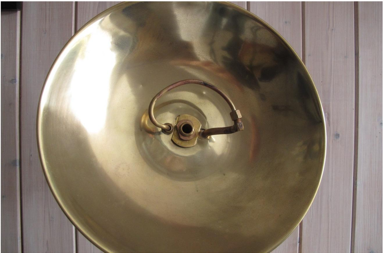
Voici la conduite de l'essence, qui passe d'abord au dessus du diffuseur afin de subir un préchauffage intense, puis revient derrière, vers le gicleur avant d'être mélangé à l'air et injectée dans le brûleur. Ci-dessous avec le diffuseur en place.
