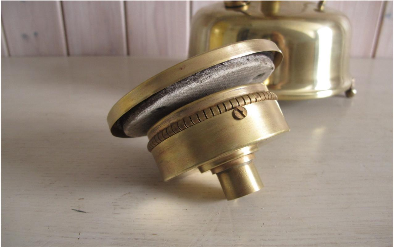
Le grand diffuseur de flamme est surmonté d'une protection épaisse en amiante, sans doute pour que la chaleur diffusée soit bien renvoyée vers la parabole.
