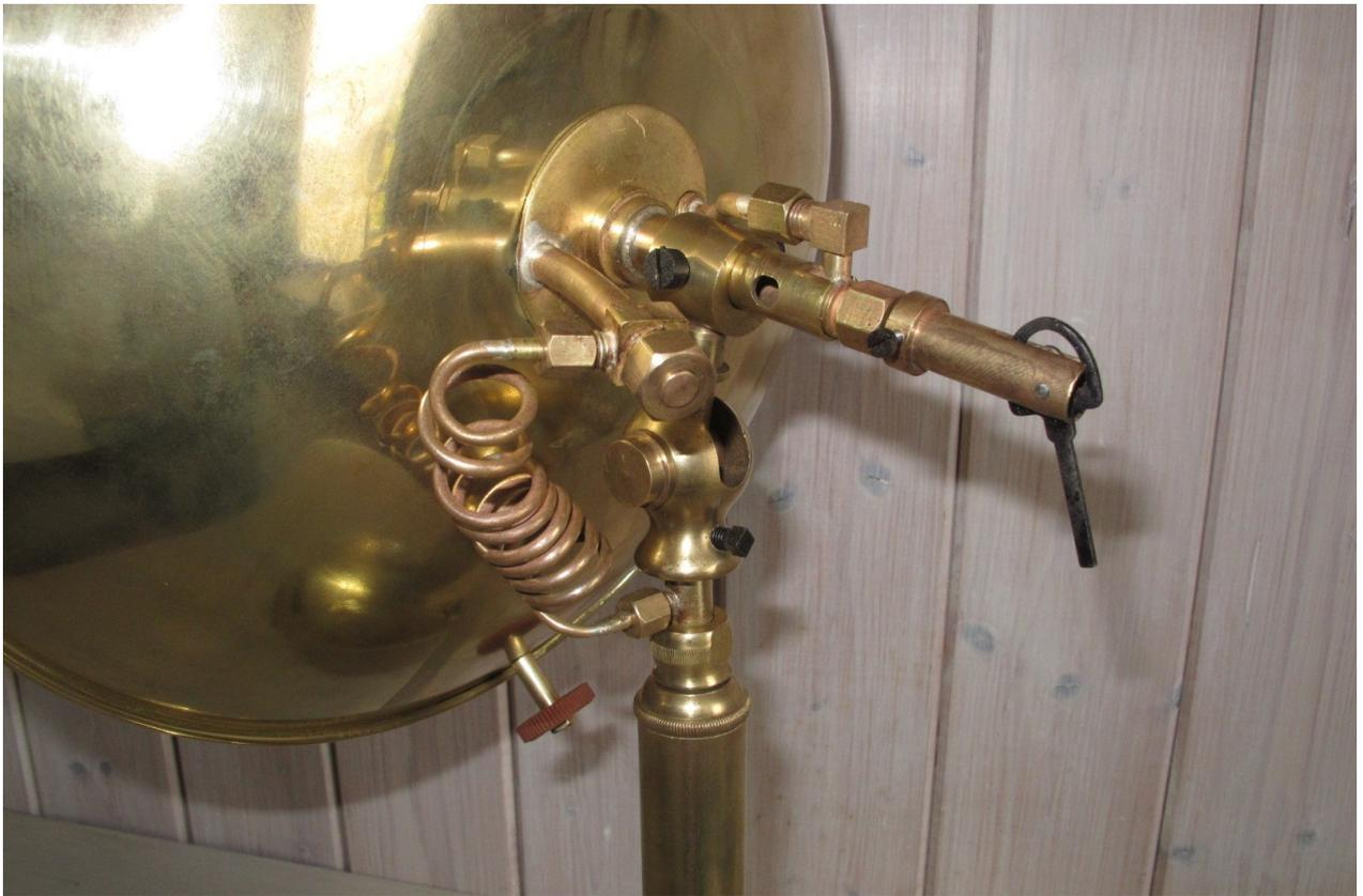
Mais ce n'est absolument pas la même architecture derrière la parabole. On retrouve le système de nettoyage par aiguille breveté en 1920/22 mais le brûleur est conçu de telle façon que le carburant soit dirigé au dessus du brûleur afin d'être parfaitement vaporisé.
