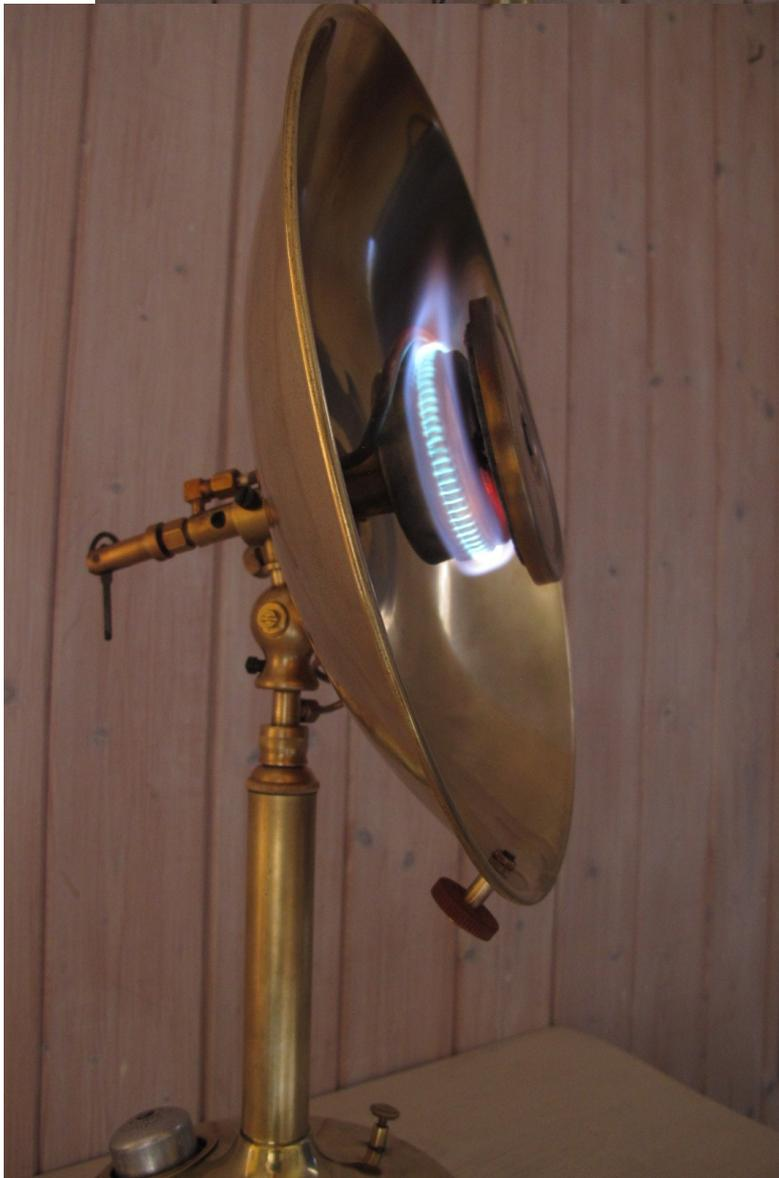
Le préchauffage se fait avec la traditionnelle « taupette » trempée dans l'alcool, enflammée et glissée derrière le brûleur. 3 minutes de chauffage et on peut commencer à pomper doucement et c'est parti !!!
