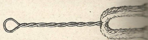
TAUPETTE à tremper dans l'alcool pour chauffer et allumer le bec.
