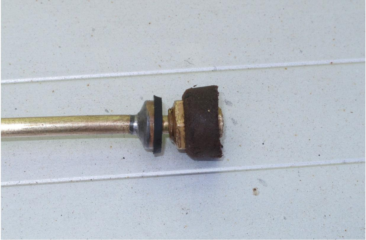
On trouve, sur la tige poussoir de la pompe, une butée soudée suivie d'un joint souple. La pièce qui porte le cuir avance et recule librement sur environ 5 mm. Ainsi quand on tire, l'air passe et cela permet d'admettre de l'air dans le tube de pompe sans effort. Quand on pousse, la pièce qui porte le cuir se trouve appliquée sur le joint, ainsi on repousse l'air admit dans le réservoir.
