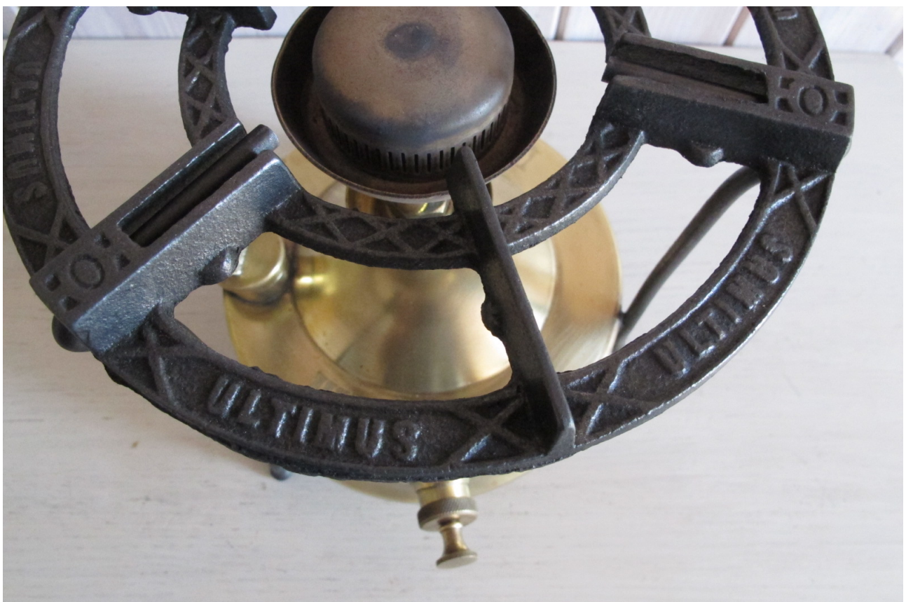
Cette belle grille en fonte d'acier signe ancienneté du réchaud. Les grilles des années 20/30 seront en tôle d'acier.
