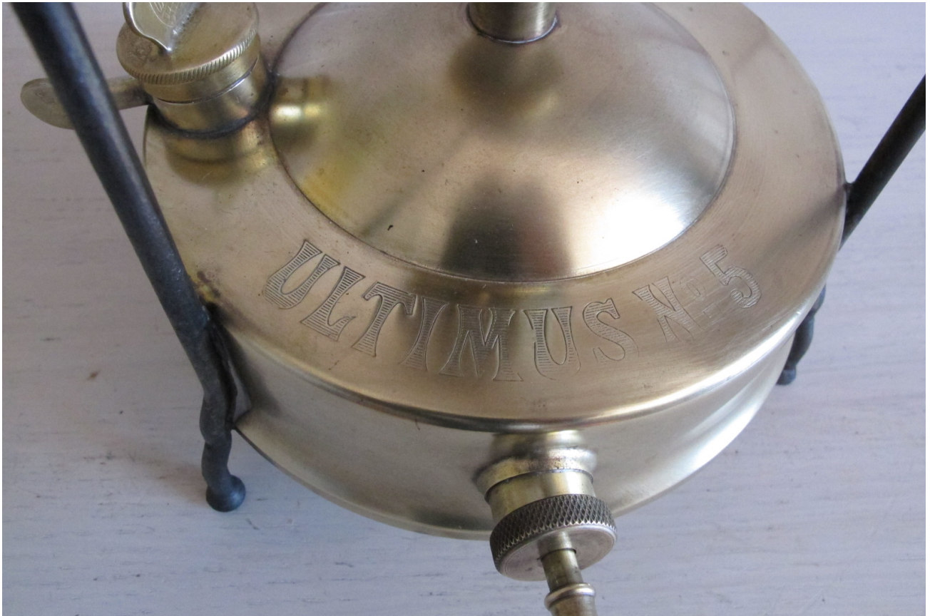
Une pompe, un bouchon de remplissage avec évent et un brûleur. Ce sont des valeurs sûres, et ça fonctionne avec une belle flamme bleue.
