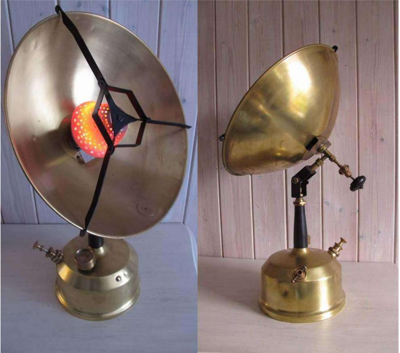
L'architecture est habituelle : manomètre de pression, pompe démontable et bouchon de remplissage/décompression sur le réservoir.
