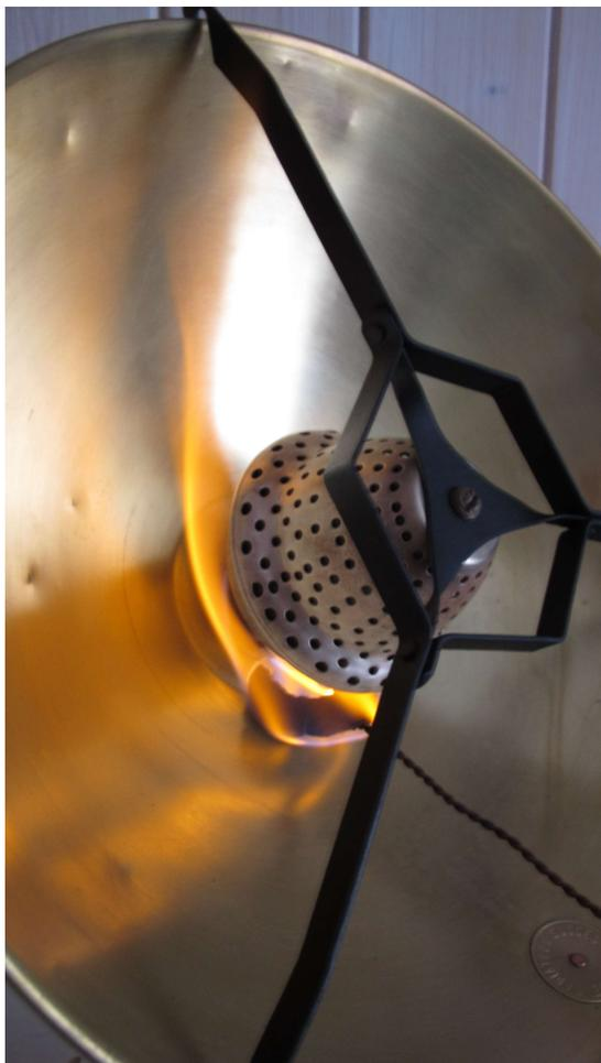
Comme pour le radiateur à pétrole, le préchauffage se fait avec la taupette, par dessous le brûleur. Après la mise sous pression du réservoir, et 2 minutes de chauffage, on dévisse le pointeau ce qui a pour effet d'extraire l'aiguille du gicleur et de laisser passer le carburant qui se vaporise et s'enflamme.
