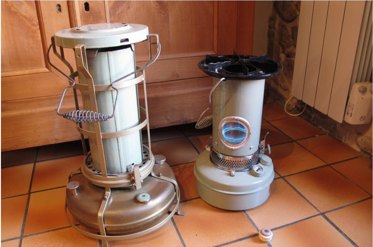
Ce petit chauffage est équipé comme le grand Aladdin de la série 15 : avec une belle jauge, en plus évidemment du bouchon de remplissage et de la manœuvre de la mèche.
