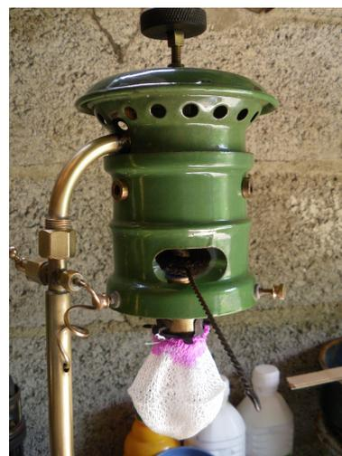
Les plus anciennes lampes tempête à pression sont munies d'une coupelle à alcool positionnée à la base du générateur. On remplit la coupelle à l'aide d'une pipette, on enflamme et on attend que la chaleur se communique avant de commencer à pomper. Le carburant monte, se vaporise dans le générateur et la flamme se communique au manchon.
