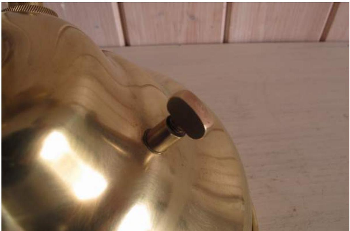
Du côté du brûleur, c'est pareil. Voilà du matériel connu chez la plupart des constructeurs de réchauds de l'époque. Mais qu'en dire de plus, sinon que ça fonctionne bien !! Il suffira d'ajouter une cloche de chauffage sur ce brûleur. La parabole est dotée d'une protection en gros fil d'acier pour éviter les brûlures. On remarque que cet appareil ne dispose pas de coupelle de préchauffage. Il faudra employer une „taupette“ de préchauffage.
