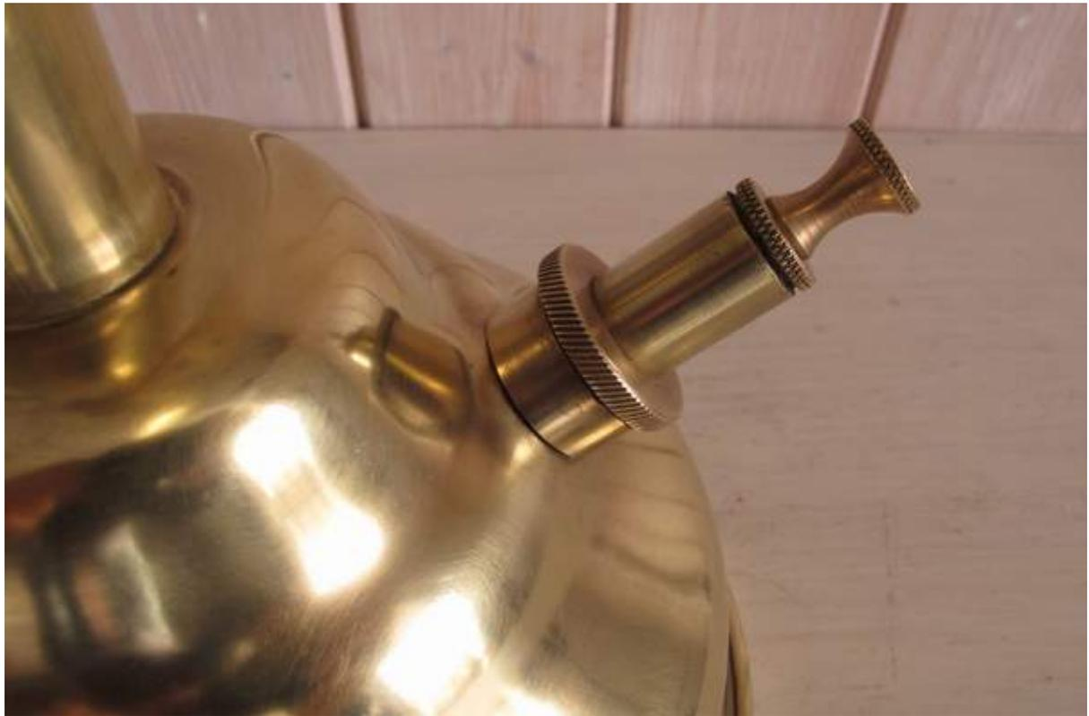
Auer, cette société prolifique, n'a rien inventé ici. Le réservoir reçoit une pompe amovible qui se visse dans le bouchon de remplissage et une vis de dépressurisation, rien que du classique, de l'éprouvé. On est certain de ne pas se tromper.
