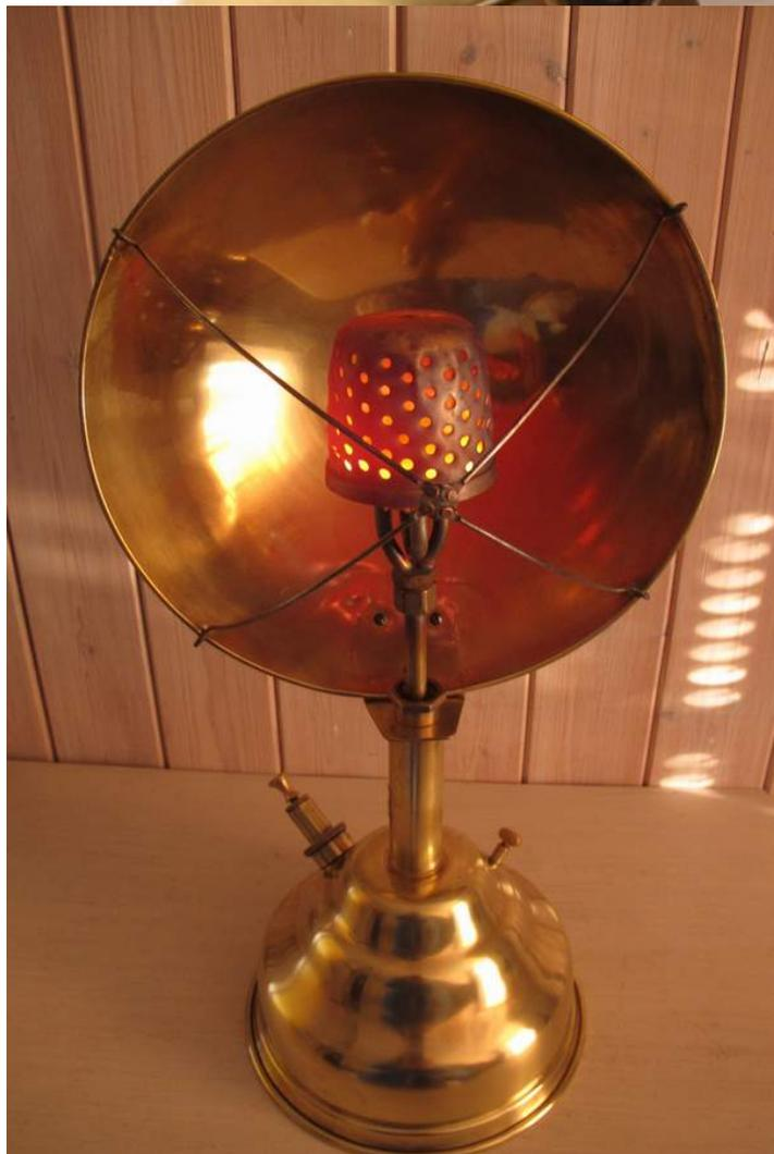
Et quand on vous dit que cela chauffe, c'est que ça chauffe. Ici, il fonctionne au pétrole, qui a un pouvoir calorifique supérieur à l'essence et qui porte bien le dôme de chauffage au rouge, condition essentielle du bon rayonnement des rayons infrarouges.
