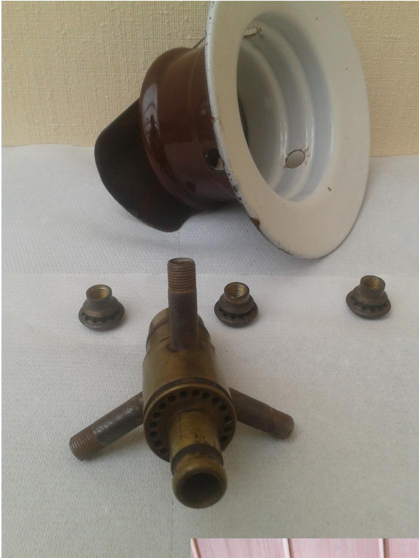
Comme toujours chez Tilley, le brûleur est fixé dans le capotage marron en son centre par 3 vis qui viennent se fixer sur les prises d'air frais. Sur ces modèles et les modèles de l'époque (SL61 et WL 25), les têtes des vis sont rondes
