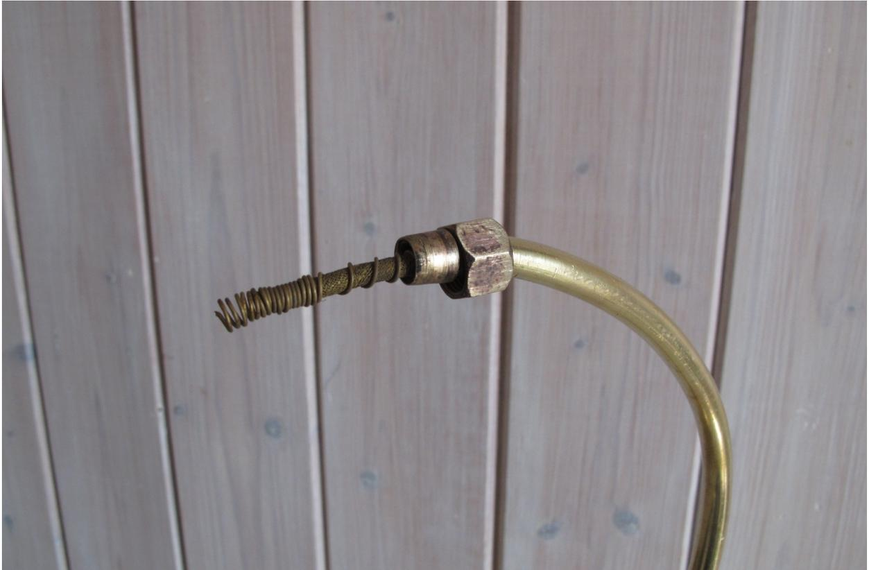
Un filtre, qui sert aussi de régulateur, est enfoncé dans le tube du col de cygne.
