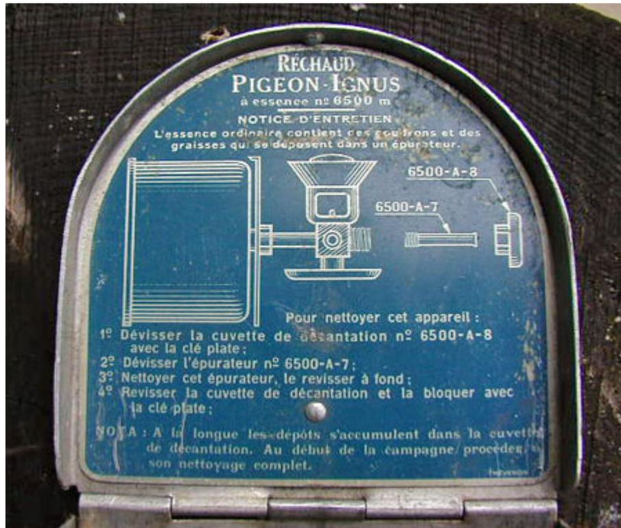
Cet engin est quasiment sans entretien . Tout juste faut-il démonter la cuvette de décantation, à l'arrière du brûleur pour enlever les impuretés une fois l'an.
