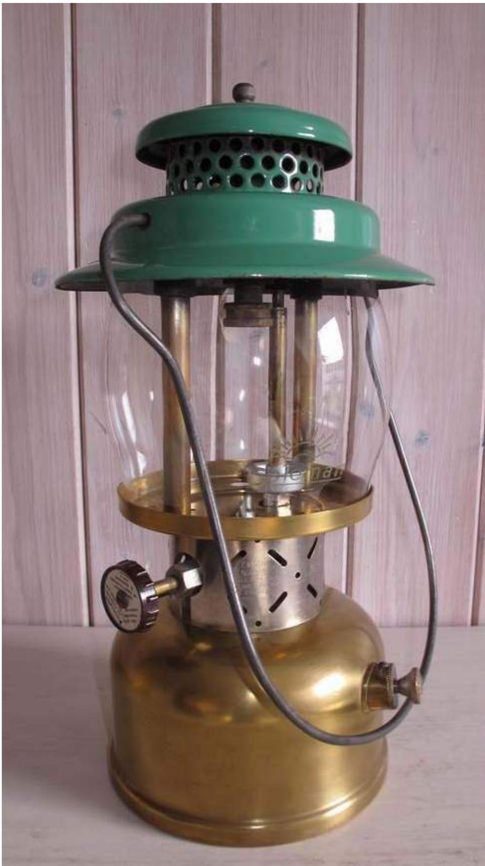
La datation des Coleman est facile, en principe. Deux chiffres sont frappés sur ou sous le réservoir pour le mois et l'année. Ainsi 46/4 signifie produite en Avril 1946. Ici nous avons A 46. Partant du fait que l'on a jamais vu de C ou de D, on s'accorde à penser (mais sans aucune certitude) que le A est pour la première moitié de l'année et le B pour les 6 mois restants.
