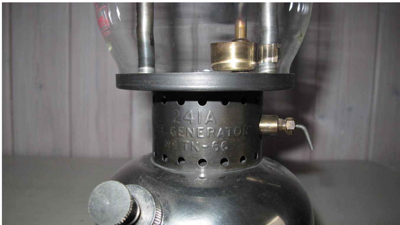
On remarque la coupelle de préchauffage à l'alcool à la base du générateur : pétrole oblige. On remarque aussi l'absence de manette de fermeture/ouverture des gaz.
