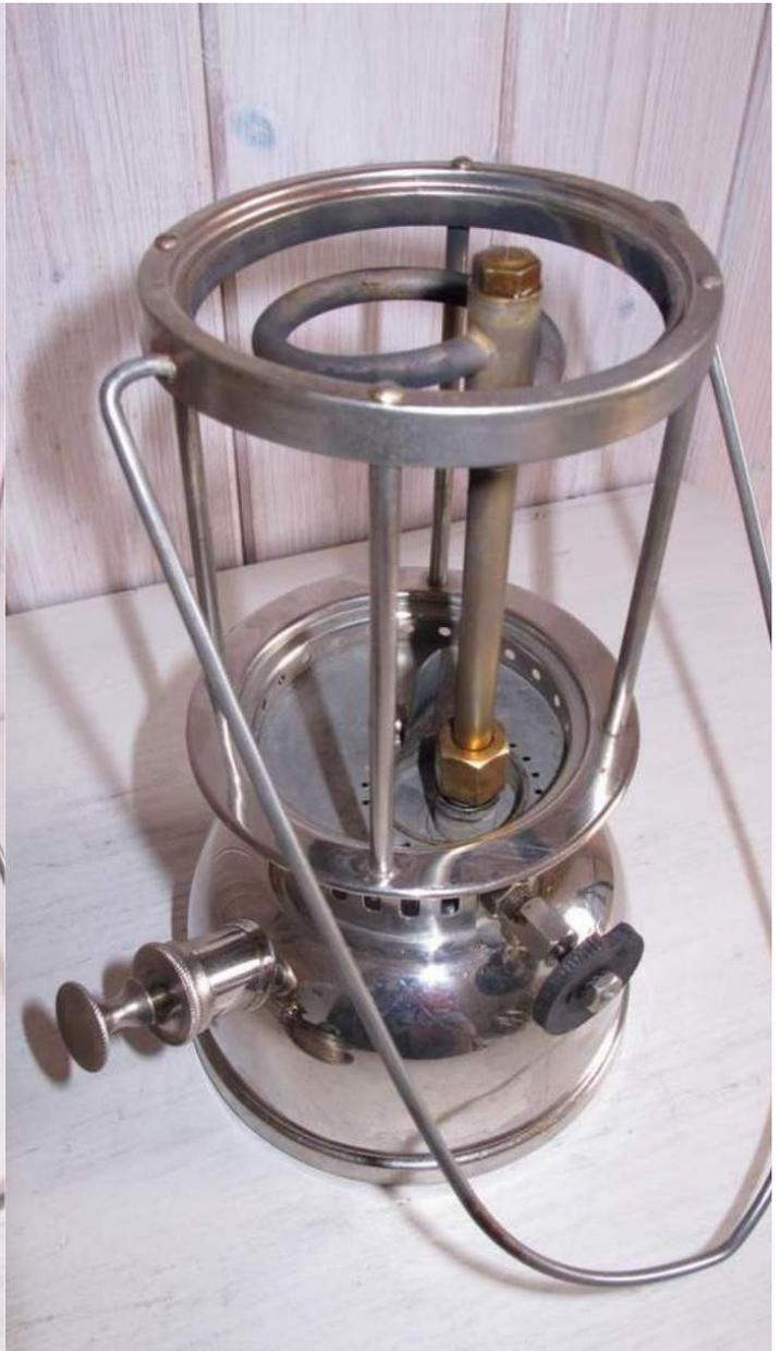
L'architecture est on ne peut plus classique. On se croirait en face d'une Petromax, avec ce générateur à loop et le tube en U renversé du brûleur alimenté par un gicleur vissé en bout du générateur. La coupelle à alcool est incluse dans la plaque qui protège le réservoir contre la chaleur. Une pompe intégrée et une manette qui commande la tige porte-aiguille. Du très classique donc ...
