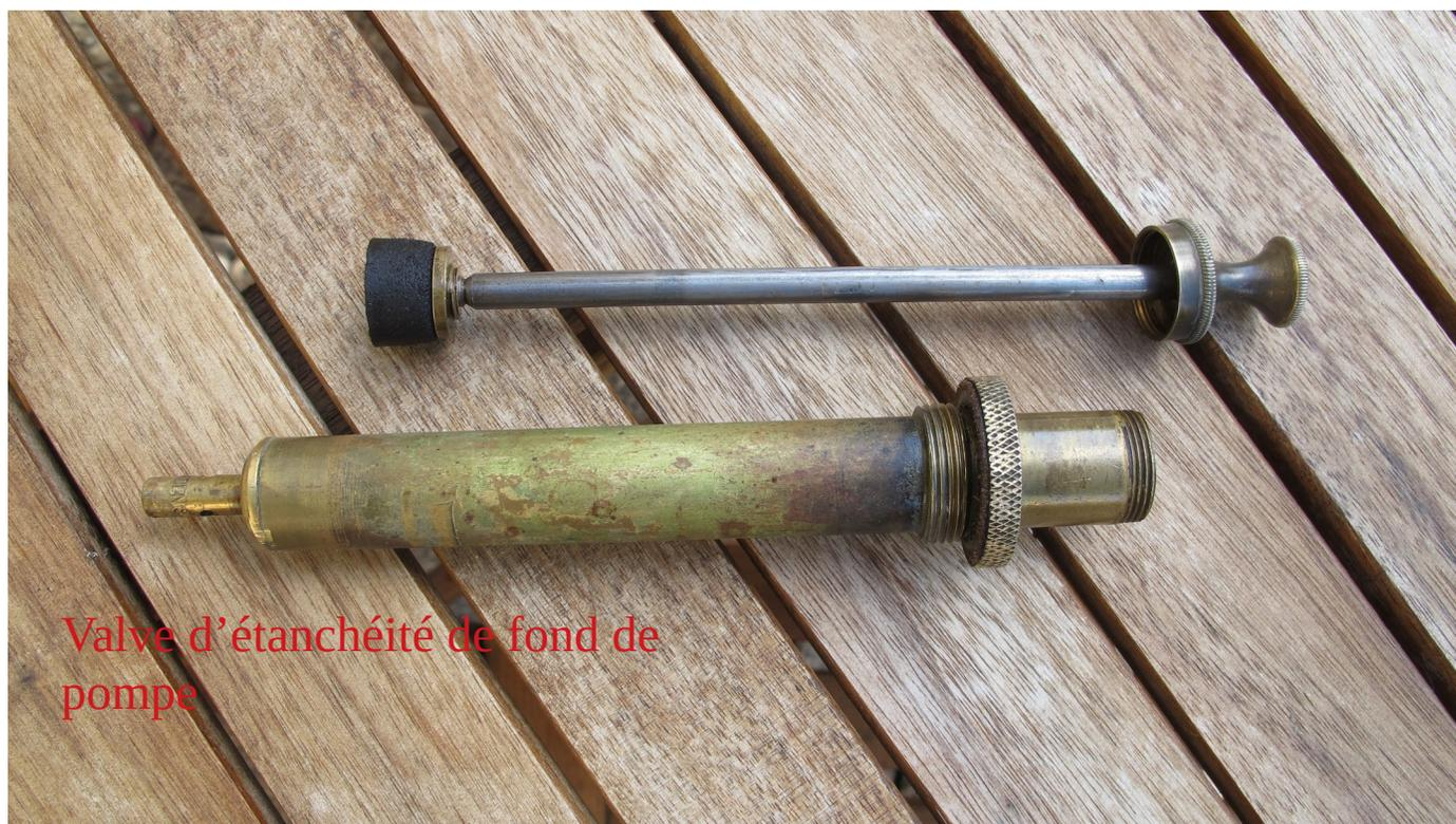
Valve d'étanchéité de fond de pompe
