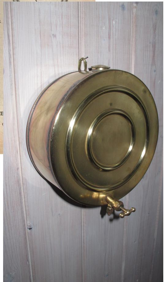
Voici un réservoir pour chute. Une mini conduite de cuivre reliera le réservoir au brûleur.
