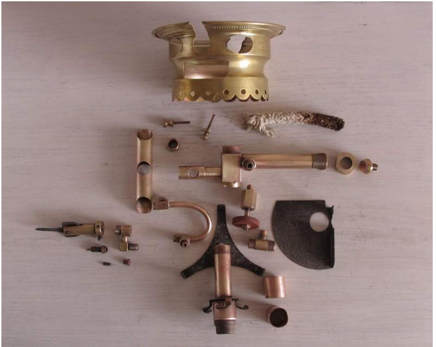
Le brûleur partiellement démonté après nettoyage. Ce sont environ 35 pièces à remonter dans le bon ordre !
