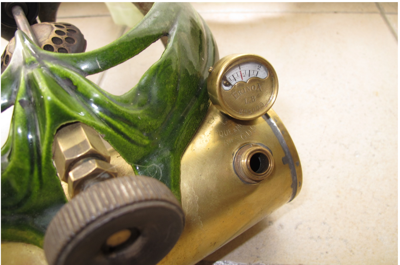
Le réservoir cylindrique est muni d'un manomètre qui, chose rare, se dévisse et sert de bouchon de remplissage.
