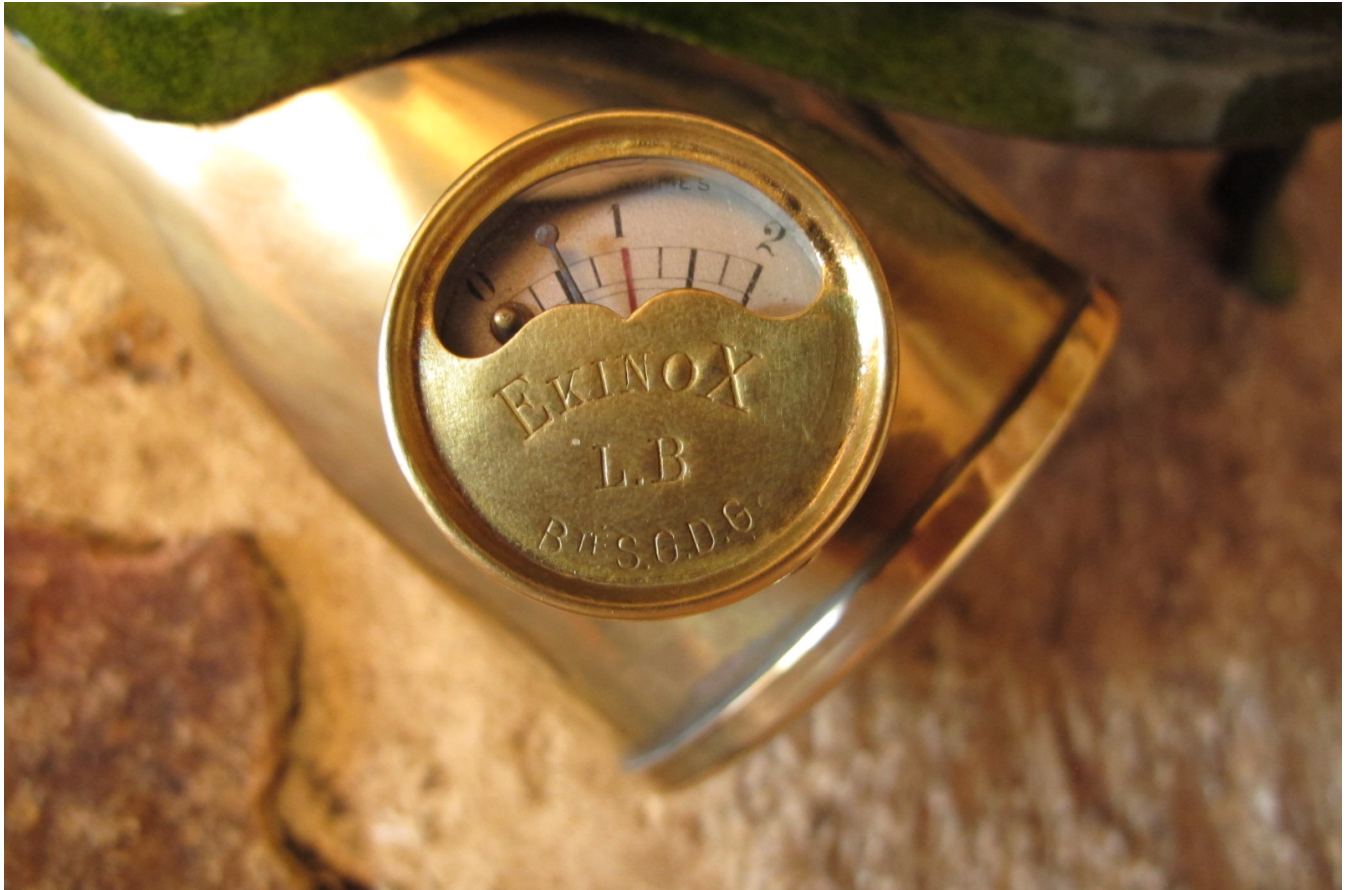
Le réservoir cylindrique est muni d'un manomètre qui, chose rare, se dévisse et sert de bouchon de remplissage.
