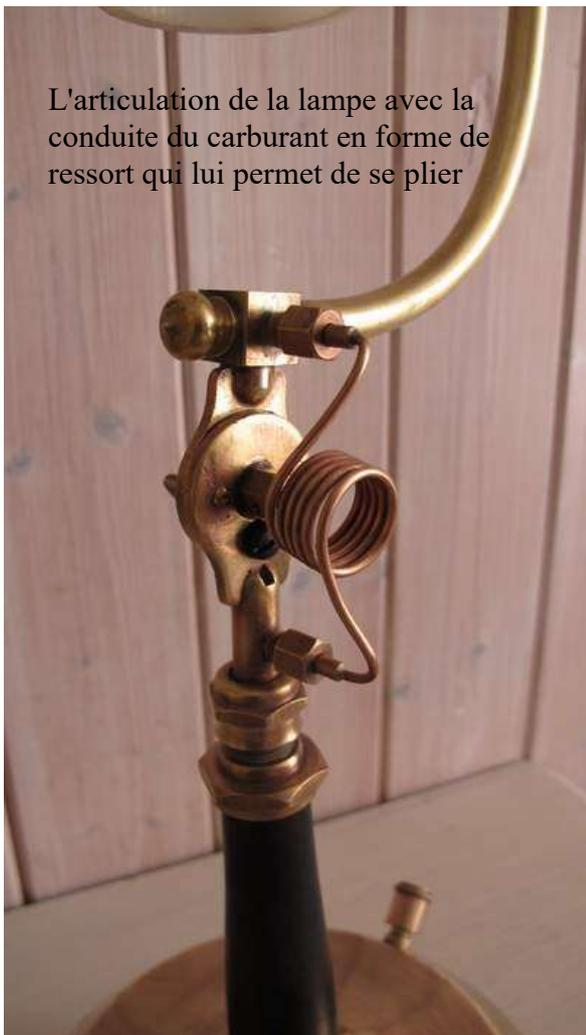
L'articulation de la lampe avec la conduite du carburant en forme de ressort qui lui permet de se plier
