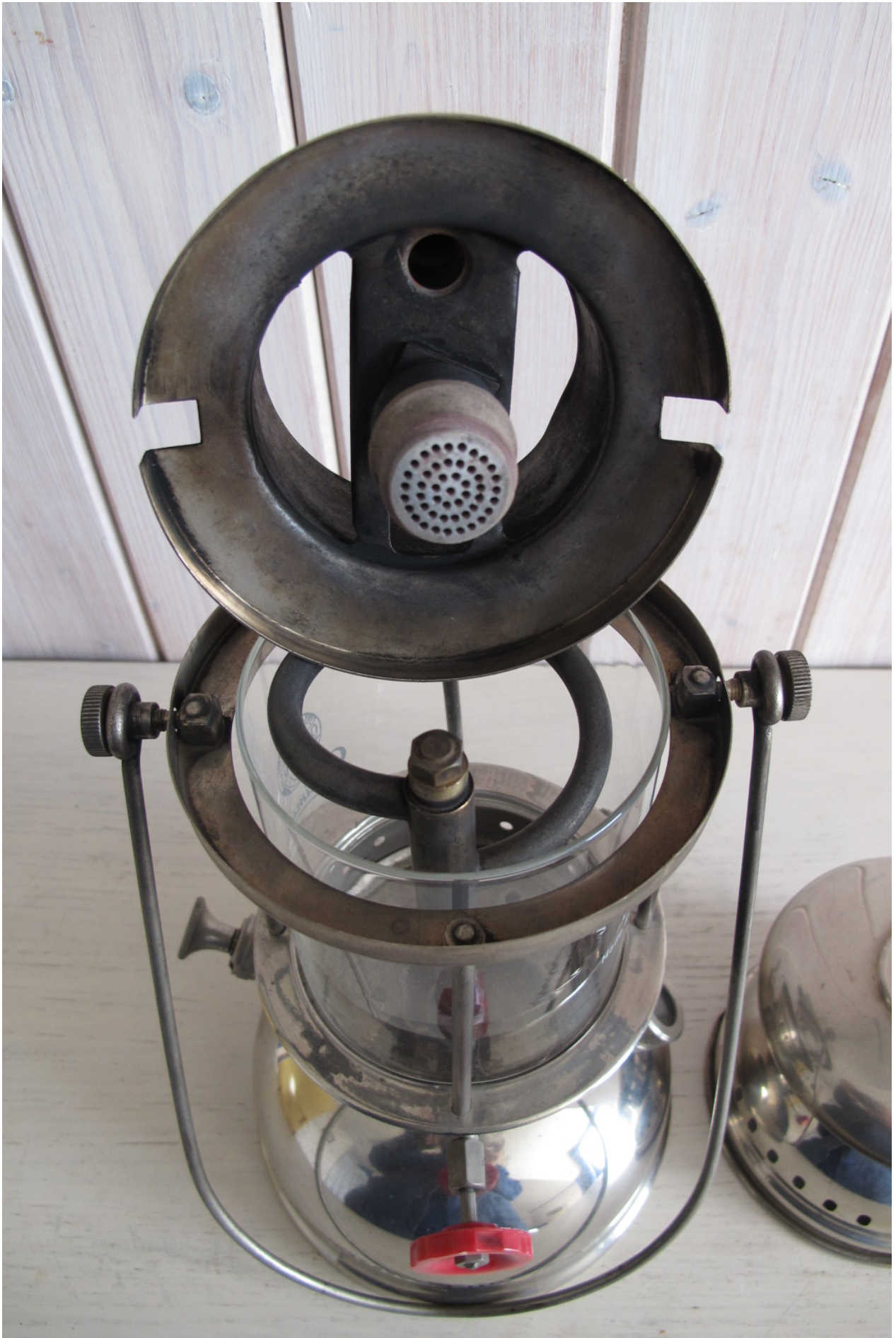
La construction est classique avec le générateur en “loop” de chez Petromax.
