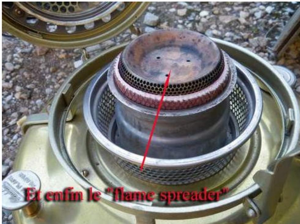
Ce "flame spreader" ou diffuseur de flamme est très important car c'est lui qui va guider l'air frais venant de dessous le chauffage juste au niveau supérieur de la mèche et permettre d'avoir une combustion parfaite du pétrole.
