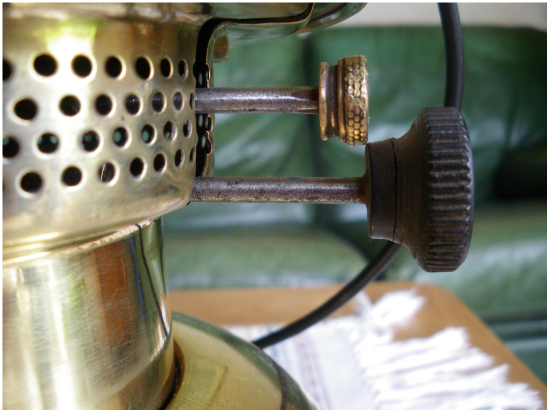
Les deux manettes du bec. Celle du haut est bien chaude en fonctionnement!
