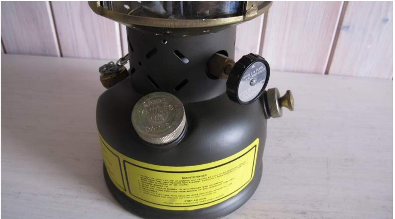
Les instructions de nettoyage et de fonctionnement sont collées sur le réservoir. Tout est prévu pour une utilisation pratique : l'entonnoir tenu par une chaînette, le petit logement pour les pièces de rechange.
