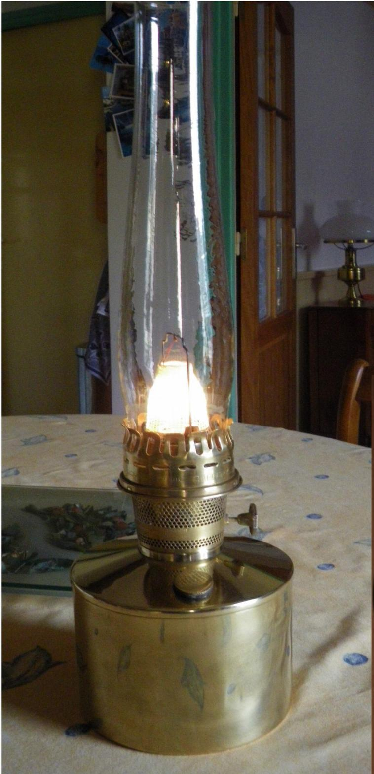
Voici une telle lampe de secours. Le brûleur (heeless) est issu d'une Aladdin 23. Il est vissé sur une cuve cylindrique de près de 2 litres de pétrole pour avoir une grande autonomie. La flamme de la mèche circulaire éclaire un manchon. La cheminée est en verre soufflé. Cette lampe pouvait être équipée d'un réflecteur parabolique pour concentrer les rayons lumineux. Un lourd socle lui assurait une bonne stabilité.
