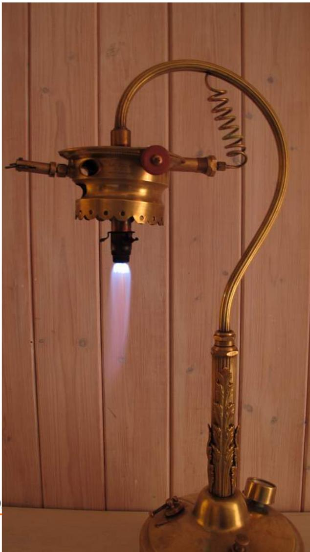
Après réfection de tous les joints, la recherche et la correction d'éventuelles fuites, on opère un bon préchauffage à l'alcool puis la mise en pression pour le premier essai. On ouvre la manette de l'essence et c'est parti.....après quelques hoquets, voici la belle flamme bleue de l'essence vaporisée,
