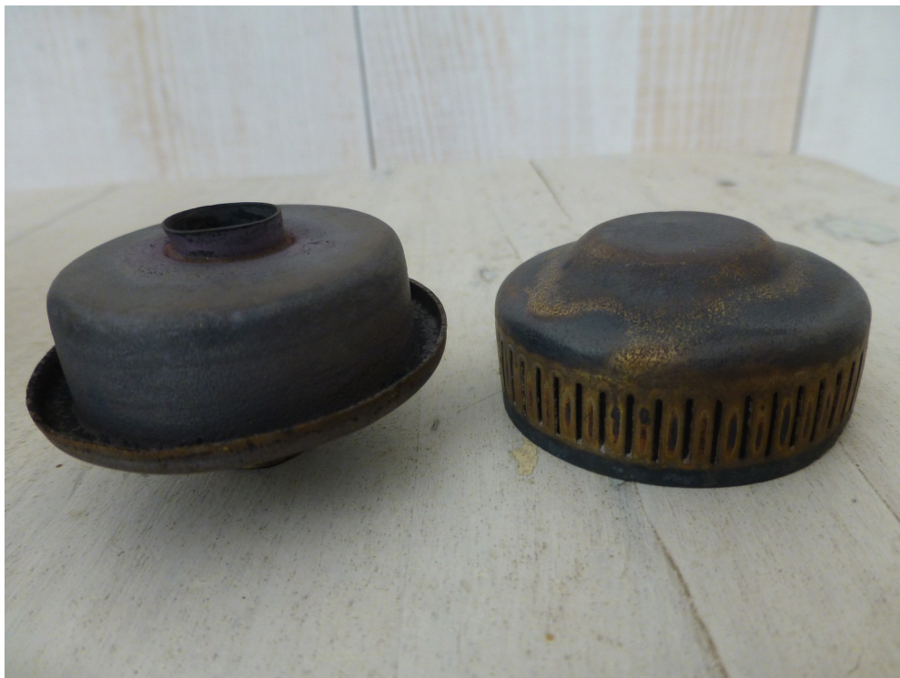
Le diffuseur du réchaud en détail.
