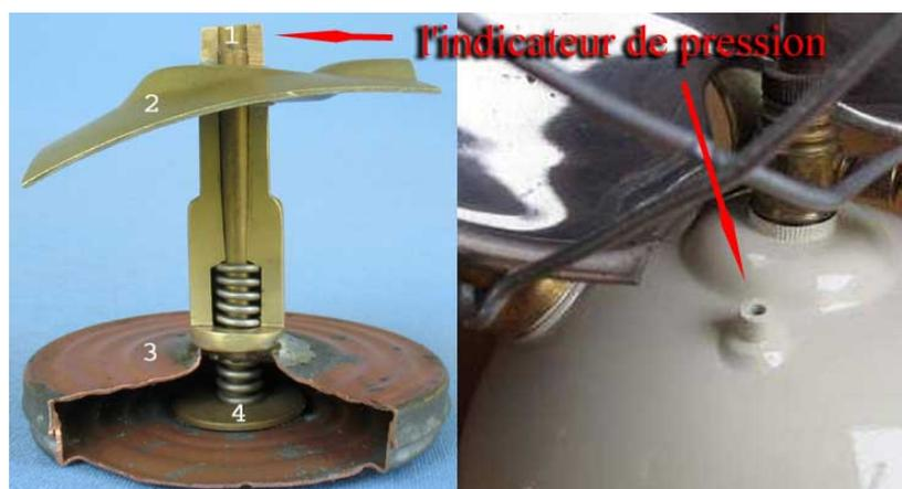
Le radiateur est muni d'un indicateur de pression optimum.
