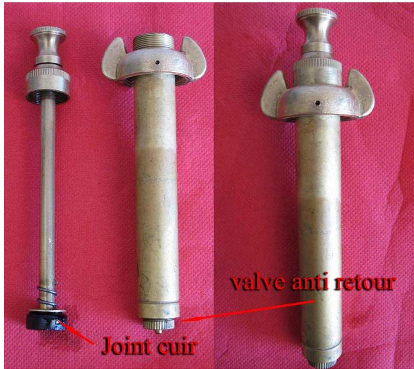
La pompe de ce radiateur Tilley se démonte entièrement. Elle inclue le bouchon de dépressurisation.
