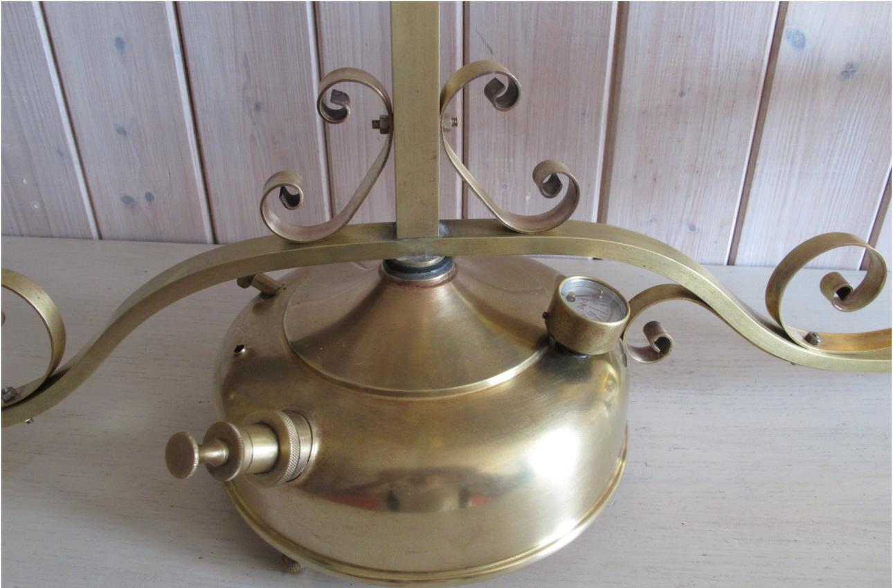
La pompe est amovible ce qui est bien pratique pour l'entretien. Le réservoir reçoit un manomètre signé P&M et une vis de dépressurisation pour stopper la lampe.
