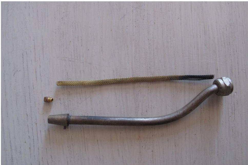
Le vaporisateur est réduit au plus simple : un tube rempli d'une gaze de laiton pour ralentir le flux du carburant et lui permettre de se vaporiser et un gicleur vissé en bout . Le cône reçoit le brûleur qui est doté d'un cône femelle de même dimension.
